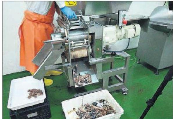
■ La planta piloto para la valorización de los descartes pesqueros está instalada en el Puerto de Marín. El proyecto *iSEAS* continúa realizando pruebas para la obtención de productos de alto valor añadido, como la obtención de bloques de músculo. Para ello, en la sección destinada a la elaboración de productos para consumo humano se separó
